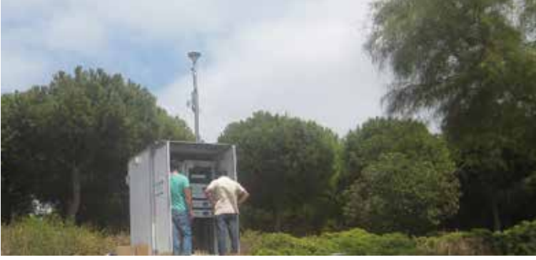
تركيب آلة لمراقبة نوعية الهواء في غابة صنوبر (الصورة من ن. مصري)
